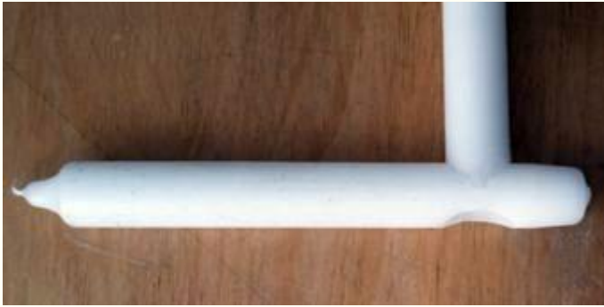
Abb.8 Türdrücker-Modell aus zwei Wachskerzen mit Daumenmulde
