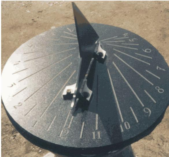
Abb.2 Horizontale Sonnenuhr nach dem Polstab-Prinzip (Stolpen/D)
